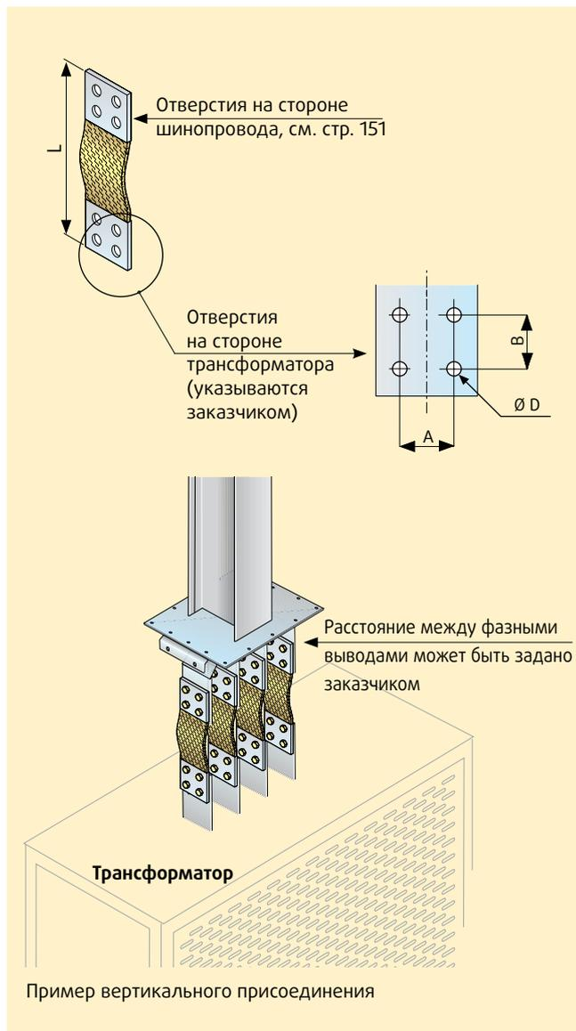
При заказе укажите сведения о крепежных отверстиях на стороне трансформатора: размеры А, В, Ø D и длина L.
