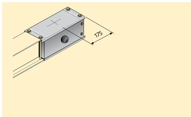
Обеспечивает степень защиты IP55 на конце трассы
