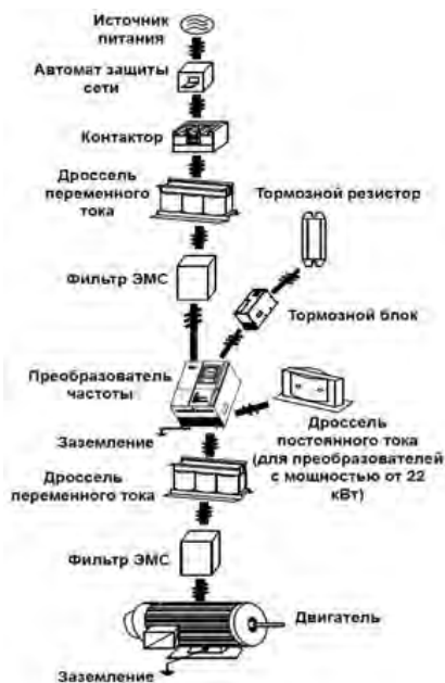
Рис. 1-2. Подключение преобразователя частоты
